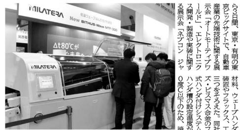
生産時のCO2排出量を15%以上削減する低温ウェーブハンダ付け装置（千住金属工業アース）
