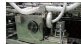
最新鋭クロスノズルヒータ Cutting-edge cross-nozzle heater 冷却ファン Cooling fan 加熱部フラックス回収機構 Heated zone flux management system
