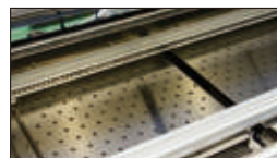
最新鋭クロスノズルヒータ Cutting-edge cross-nozzle heater 冷却ファン Cooling fan 加熱部フラックス回収機構 Heated zone flux management system
