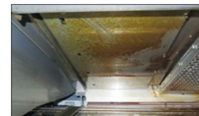
フラックス回収機構OFF Flux management system OFF
