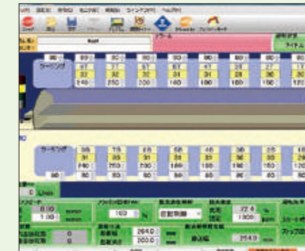
8ブロックまたは全ブロックファン制御 8 or all block fan control
