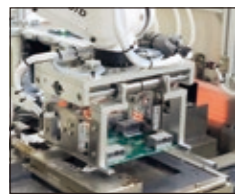
ロボットが基板をノズルに搬送 The robot conveys the PCB to the nozzle
