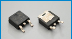
● 電子機器に使用される、小型のパワートランジスタ。本体裏面の広い金属面が、放熱のためのはんだ付け部分です。
