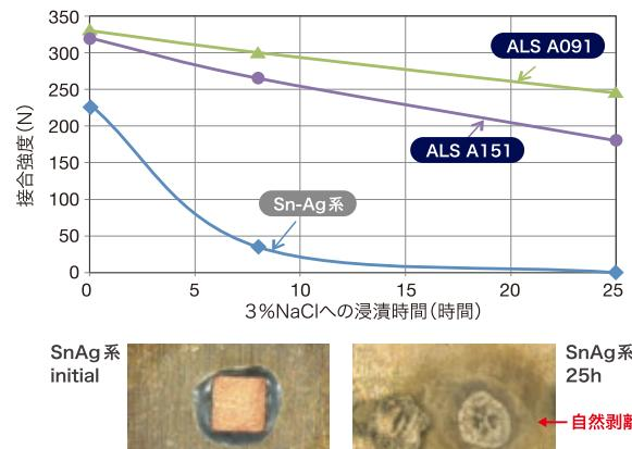
2種のはんだとAlの接合界面Al-Sn間とAl-Zn間では、Al-Sn間の方が標準電位差は大きく、3%NaClによる腐食試験25時間では、ガルバニック腐食で剥離した。
