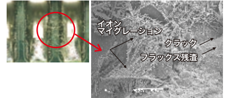
結露した水が残ると、容易にイオンマイグレーションが発生する
