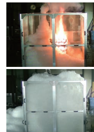
「AwaAwa10」での消火試験
