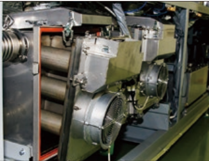
加熱部フラックス回収機構 工具レスで簡単メンテナンス Flux management system Tool-free easy maintenance
