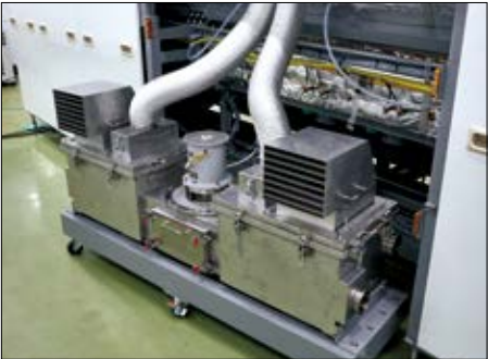
加熱部フラックス回収機構 工具レスで簡単メンテナンス Flux collection system Tool-free easy maintenance
